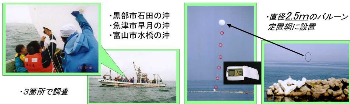
第5図 生地沖，魚津沖，水橋沖の定置網の浮きに気象観測用バルーンを係留
