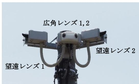
図4 新たに設置した定点カメラ
