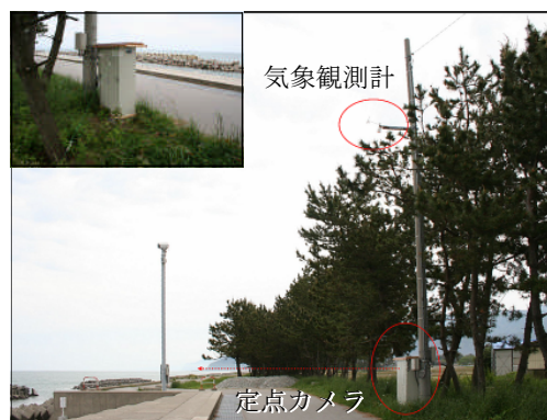
第2図 定点カメラと気象観測計
